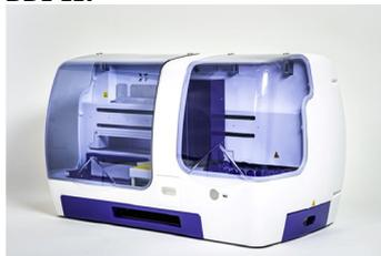
*BlueDiver Instrument II je přístroj, který zajišťuje různé kroky pipetování vzorků, inkubace, promývání, sušení a čtení proužků imunodot společnosti D-tek, od uložení zkumavky se vzorkem až po konečné čtení proužků. Maximální kapacita přístroje BDI II je 24 proužků, které lze inkubovat současně. Každý proužek je asociován s kazetou obsahující různá činidla, která umožňují provést test. Přístroj BDI II má čtečku čárových kódů, která řídí správnou asociaci mezi proužkem a jeho kazetou.*
